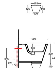
Esempio installazione vaso e bidet semisospesi - Utilizzare staffa di fissaggio vaso / bidet sospesi
